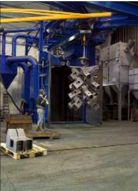
Das Bestücken der Strahlanlage erfolgt vollautomatisch. Fotos (2): Graubmann
